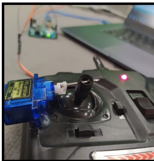
Рис. 2. Соединение сервопривода с ПДУ
