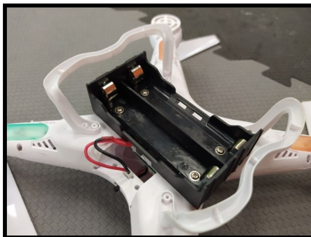
Рис. 1. Замена аккумулятора для увеличения его емкости
