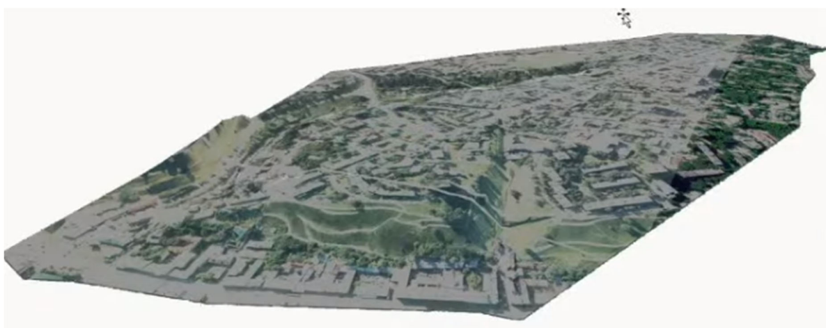
Рис. 3. Цифровая модель рельефа, полученная текстурированием ортофотоплана
