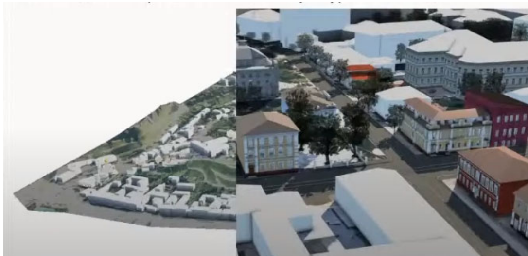
Рис. 5. Интеграция ВІМ-моделей в цифровую модель территории
