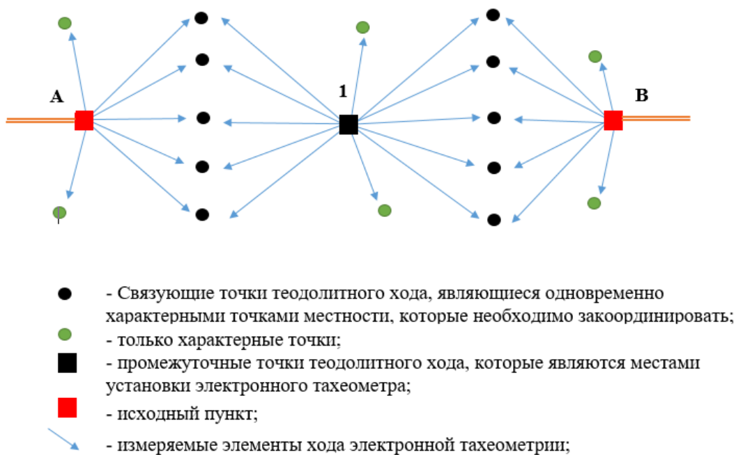
Рис. 1. Схема построения хода электронной тахеометрии
