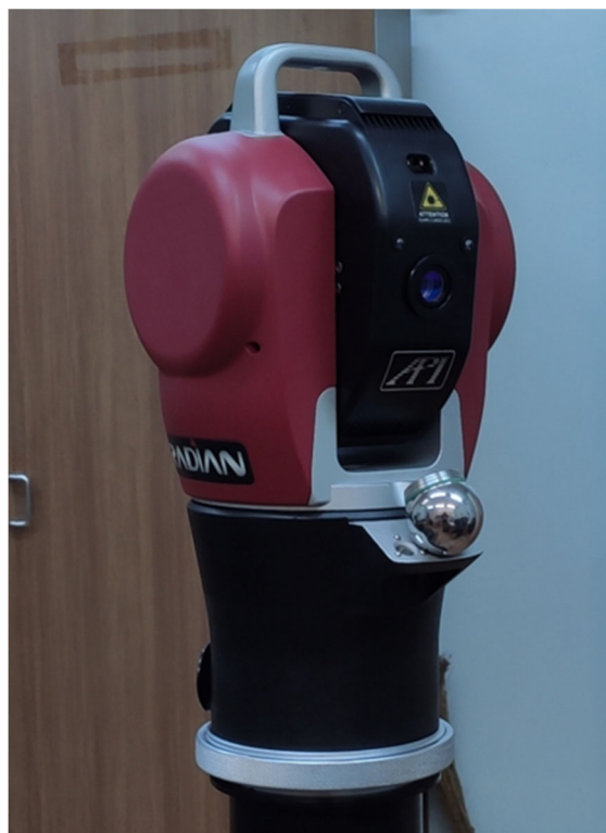
Рис. 4. Лазерный трекер API Radian R-80
