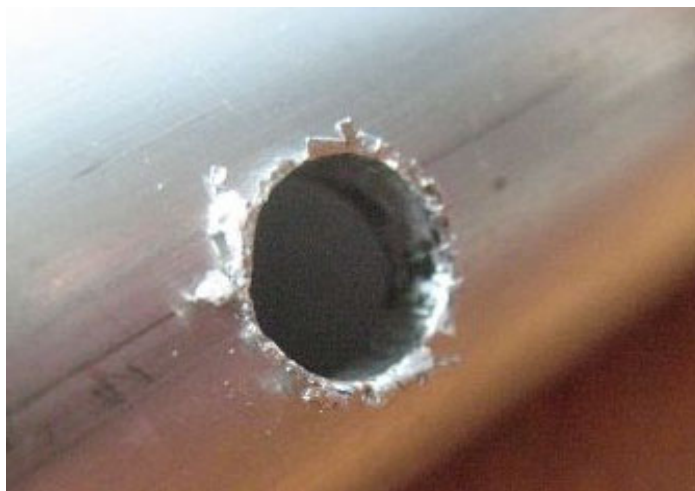
Рис. 1. Изображение отверстия в трубе с заусенцами
