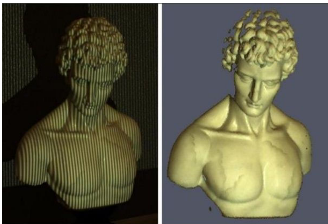
Рис. 1. Пример реконструкции с использованием структурированного света
