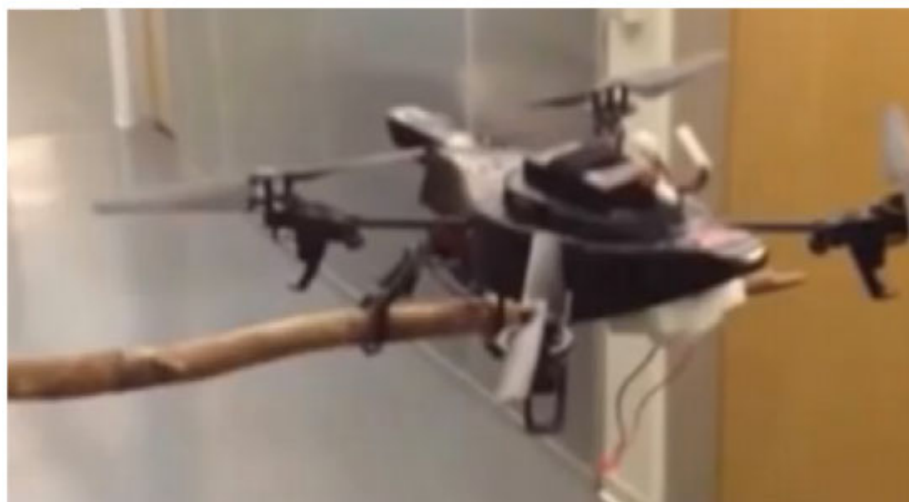
Рис. 3. Дрон с лапками, который может сесть на ветку дерева [17]
