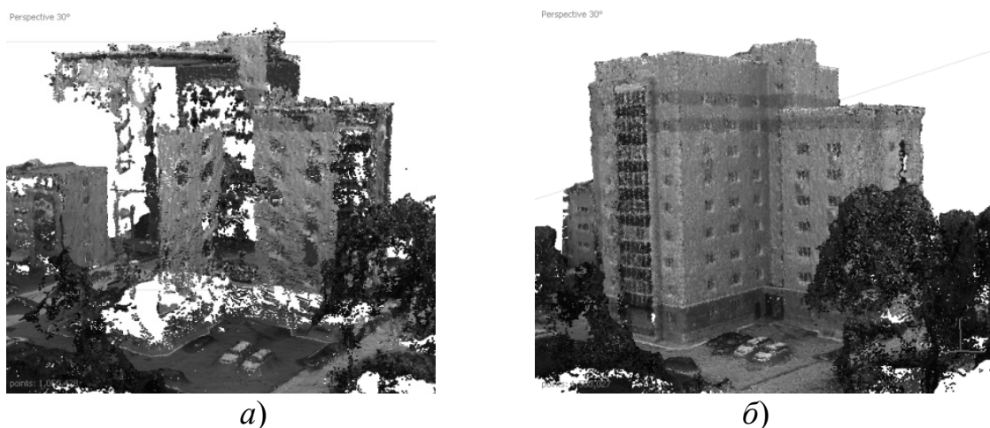
Рис. 2. Точечная цифровая модель городского здания, полученная: а) по данным плановой съемки с применением БПЛА; б) в результате комплексной обработки данных плановой и перспективной съемки
