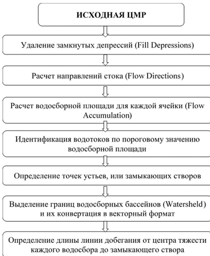
Рис. 1. Алгоритм схематизации речной сети и выделения речных бассейнов по ЦМР
