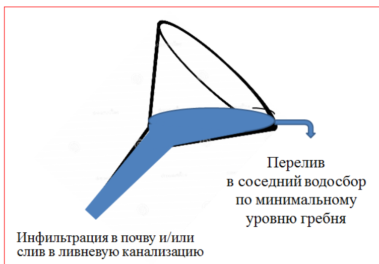
Рис. 1. Вороночная модель одного водосбора (фации)
