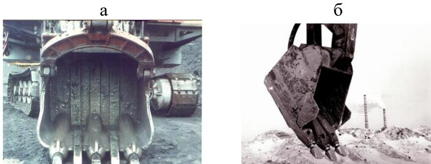
Рис. 12. Общий вид ковша с ударными зубьями экскаваторов ЭКГ-5В (а) и ЭО-4121
