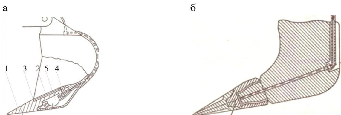
Рис. 4. Ковши с вибрирующими зубьями: а) патент № 2317424 Франция [2], б) с приводом от гидровибратора (патенту № 2082069 Франция)
