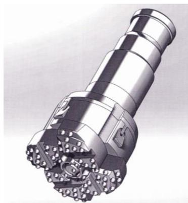
Рис. 5. Новая конструкция долота под трубу Ø 325
