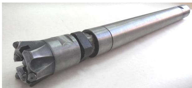
Рис. 2. Экспериментальный образец погружного пневмоударника ПНБ76
