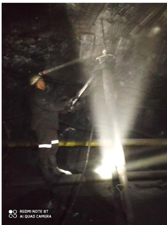
Рис. 6. Промышленные испытания пневмоударника АШ 43 на станке СБР
