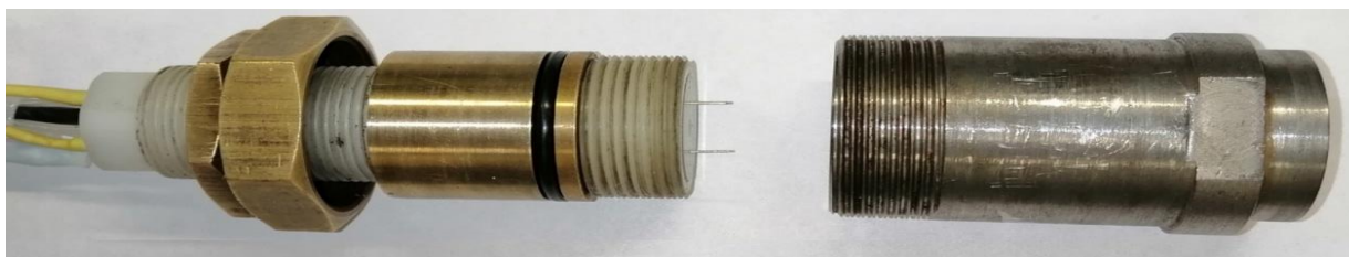
Рис. 1. Датчик измерителя сопротивления в разобранном виде
