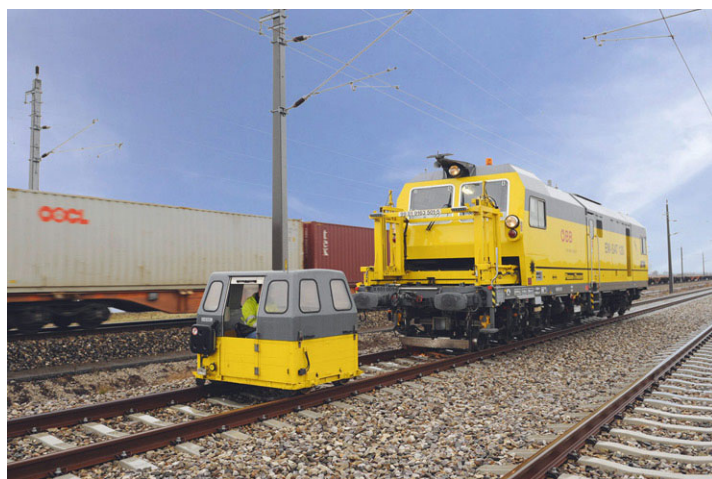
Рис. 3. Система выправки пути EM-SAT
