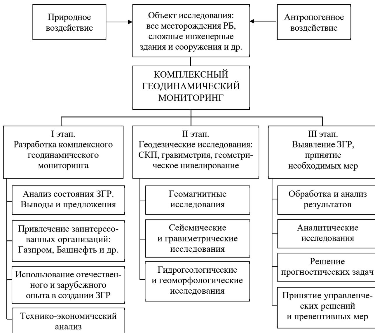
Рис. 2. Технология определения зон геодинамических рисков территорий с добычей на углеводородных и рудных месторождениях
