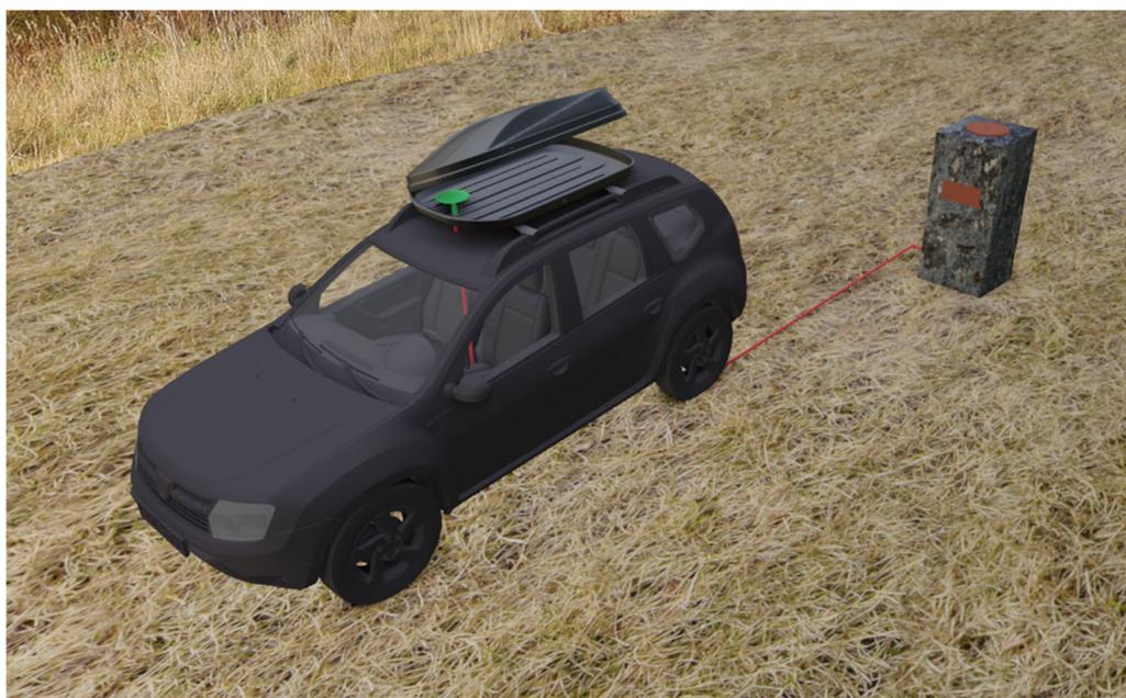
Рис. 4. Общий вид взаимного расположения автомобиля с антенной НАП-В и геодезического пилона во время геодезического контроля точности измерений
