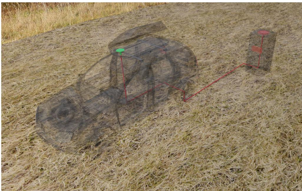
Рис. 5. Схема редукции антенны НАП-В к центру геодезического пилона
