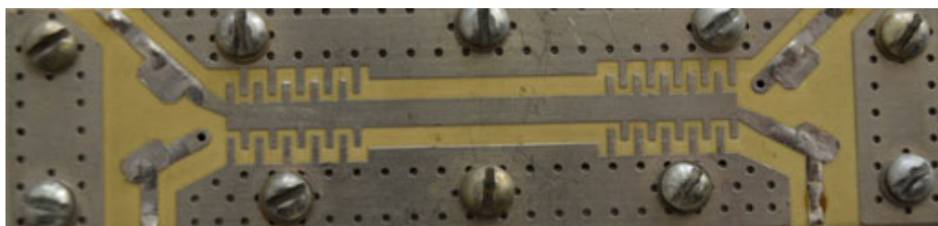
Рис.3. Экспериментальный образец 3дБ – НО с лицевой связью
