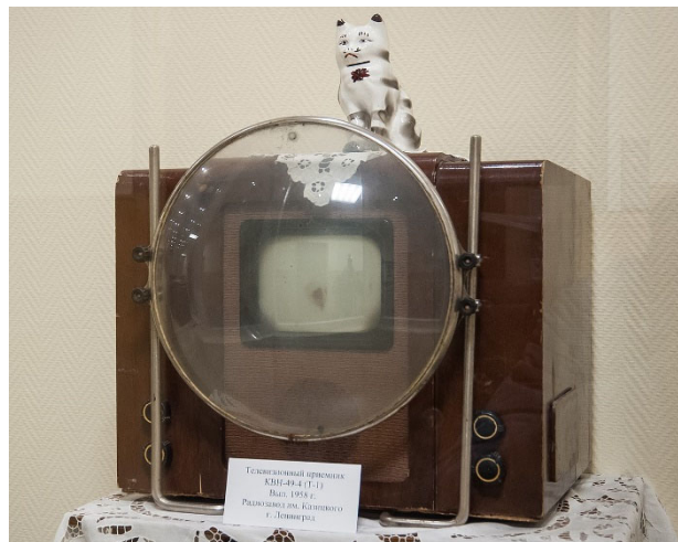
Рис. 9. Оптическая проекционная увеличивающая система первого советского телевизора КВН
