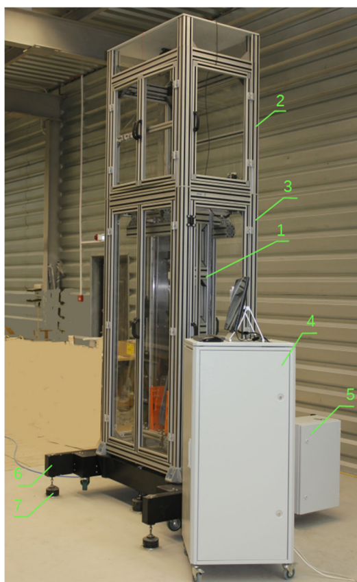
Рис. 5. Общий вид установки «Струна»: 1 – линейный привод, 2 – блок оптический, 3 – рама, 4 – стойка управления, 5 – блок электроники, 6 – основание, 7 – опора
