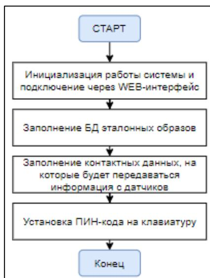
Рис. 4. Блок-схема первичного взаимодействия оператора с системой
