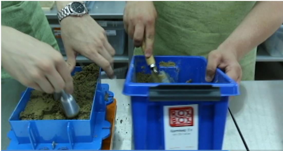
Рис. 3. Изготовление литейной формы
