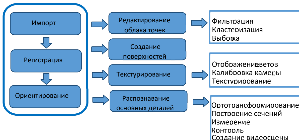
Рис. 3. Технологическая схема обработки данных мобильного лазерного сканирования в ПО Gexcel Reconstructor 4.2
