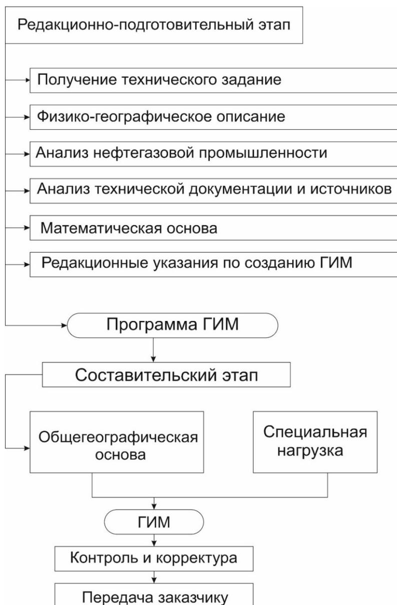
Рис. 1. Технологическая схема геоинформационного картографирования нефтегазового комплекса
