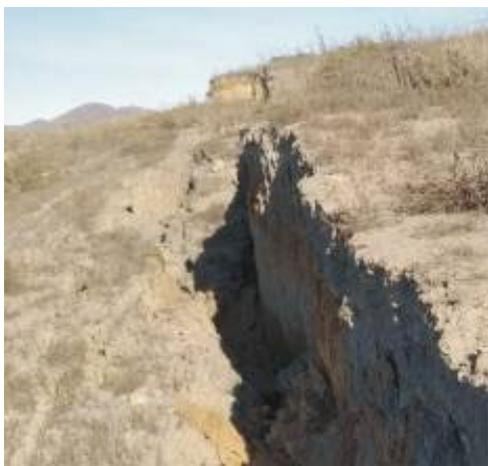
Рис. 1. Трещина в четвертичных отложениях борта
