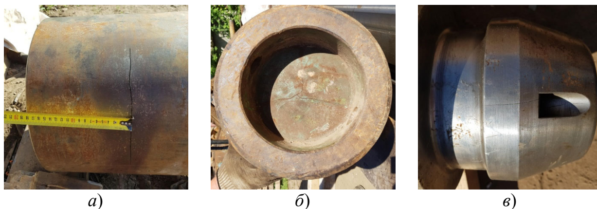
Рис. 2. Трещины в основных деталях пневмомолота с массой ударника 740 кг: а) корпус; б) наковальня; в) ударник
