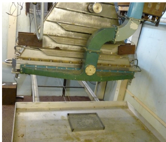
Рис. 2. Размещение транспортера и емкости с обрабатываемой рудой в помещении технологического зала ускорителя ИЛУ-6
