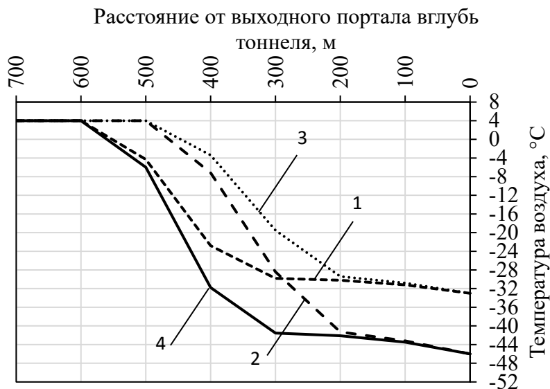
Рис. 3. Распределение температуры в зоне контакта «воздух-тоннельная обделка» на различном удалении от выходного портала тоннеля в момент выхода хвостового вагона поезда из тоннеля без учета работы припортальной отопительной установки для различных температур наружного воздуха t_{ext} и скорости движения состава v :
