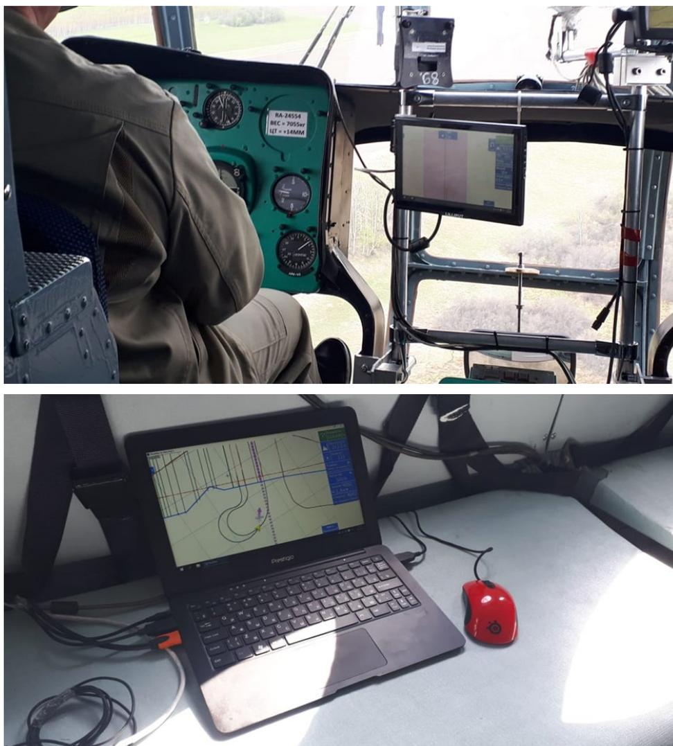
Рис. 1. Вывод НК RouteNav на экран в кабине пилотов (сверху) и на ноутбук оператора геофизической съемки (внизу)
