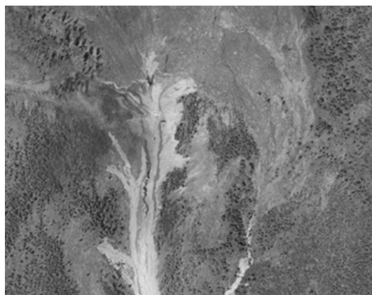
Рис. 1. Зона зарождения селя (Аршан, 2014). Признаки – V-образный врез с четкими бровками, светлый тон на темном фоне, оползни-сплывы по бортам вреза
