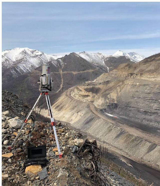
Рис. 1. Сканер RIEGL Z-420i на фоне объекта работ
