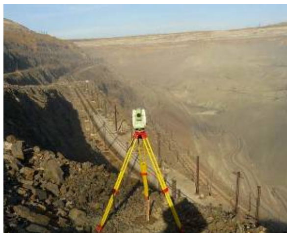
Рис. 6. Инструментальный контроль западного борта Соколовского карьера
