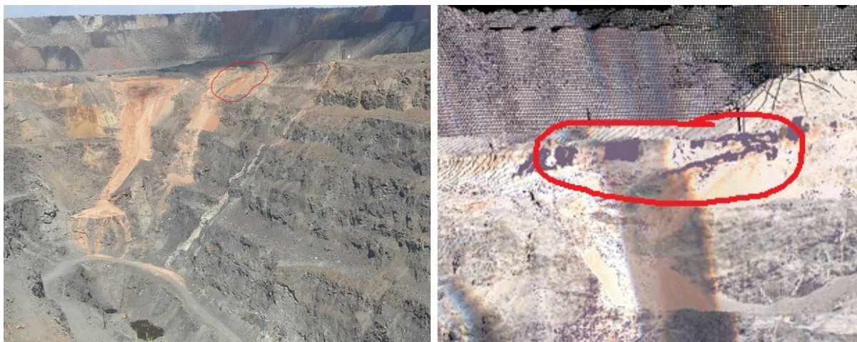
Рис. 4. Результаты сканирования верхних глинистых отложений западного борта карьере «Кентобе»
