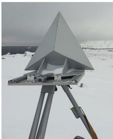
Рис. 5. Уголкового отражателя с механизмом микрометра
