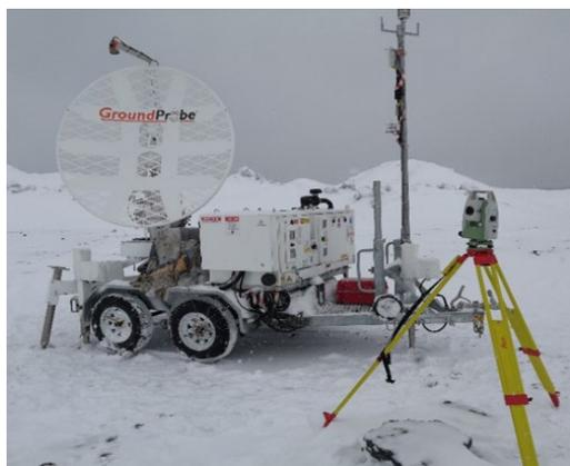
Рис. 4. Радар Ground Probe SSR-XT тахеометром Leica TS02 Plus
