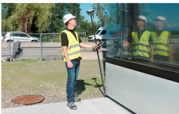
Рис. 2. Применение инерциальной системы для координирования углов здания в местах с частично закрытым небосводом
