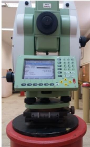
Рис. 1. Установка тахеометра с центрирующим устройством на пункте
