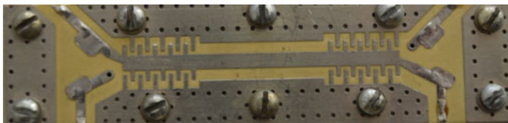
Рис.3. Экспериментальный образец 3дБ – НО с лицевой связью
