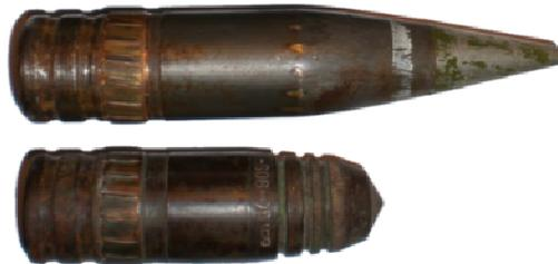
Рис. 4. Бронебойный снаряд калибром 30 мм (вверху) и его бронебойный сердечник (внизу)
