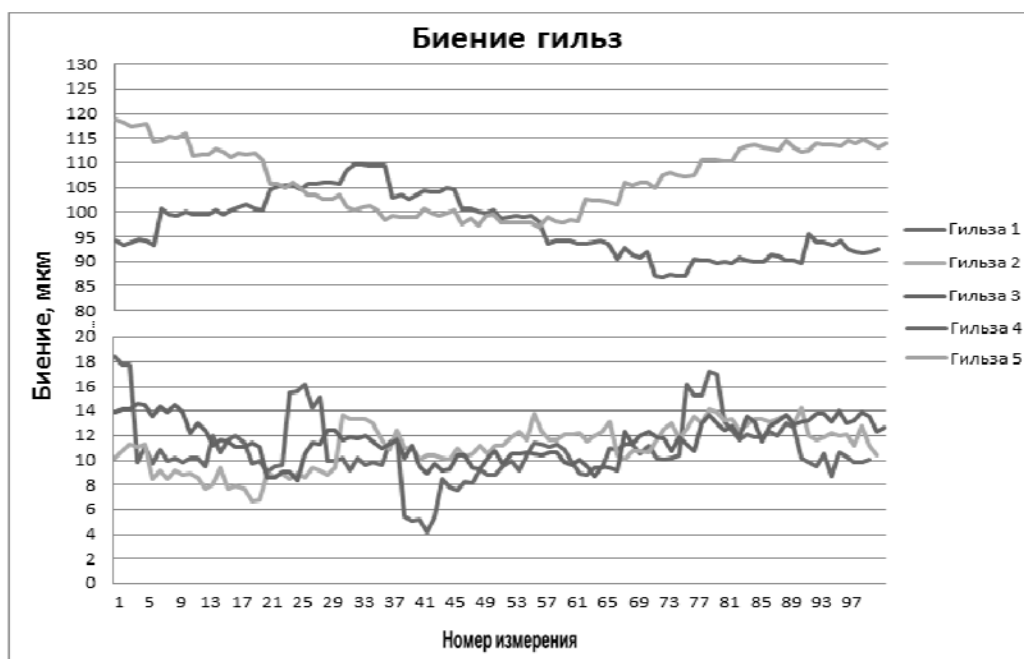
Рис. 3. Измерение биения носовой части гильз
