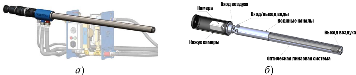
Рис. 1. Высокотемпературный эндоскоп НТО38: а) эндоскоп с насосной станцией; б) устройство эндоскопа
