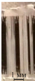
Рис. 3. Макетный образец прямоугольной формы с полосковыми металлическими тонкопленочными структурами в свободном состоянии
