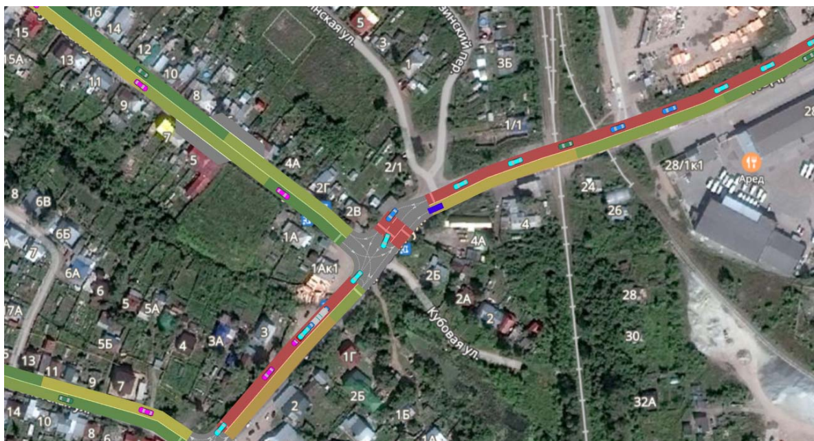
Рис. 5. Модель, отражающая ситуацию движения транспортного потока на сегодняшний день
