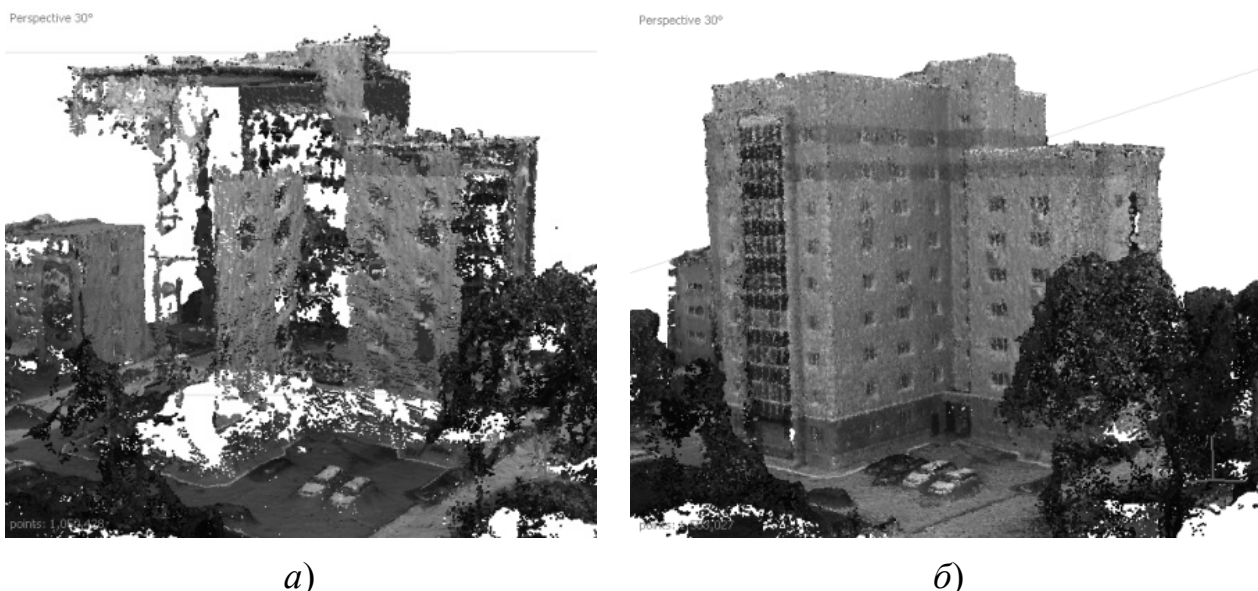
Рис. 1. Изображения точечных цифровых моделей, полученных: а) по плановым снимкам; б) в результате совместной обработки данных плановой и перспективной съемки
