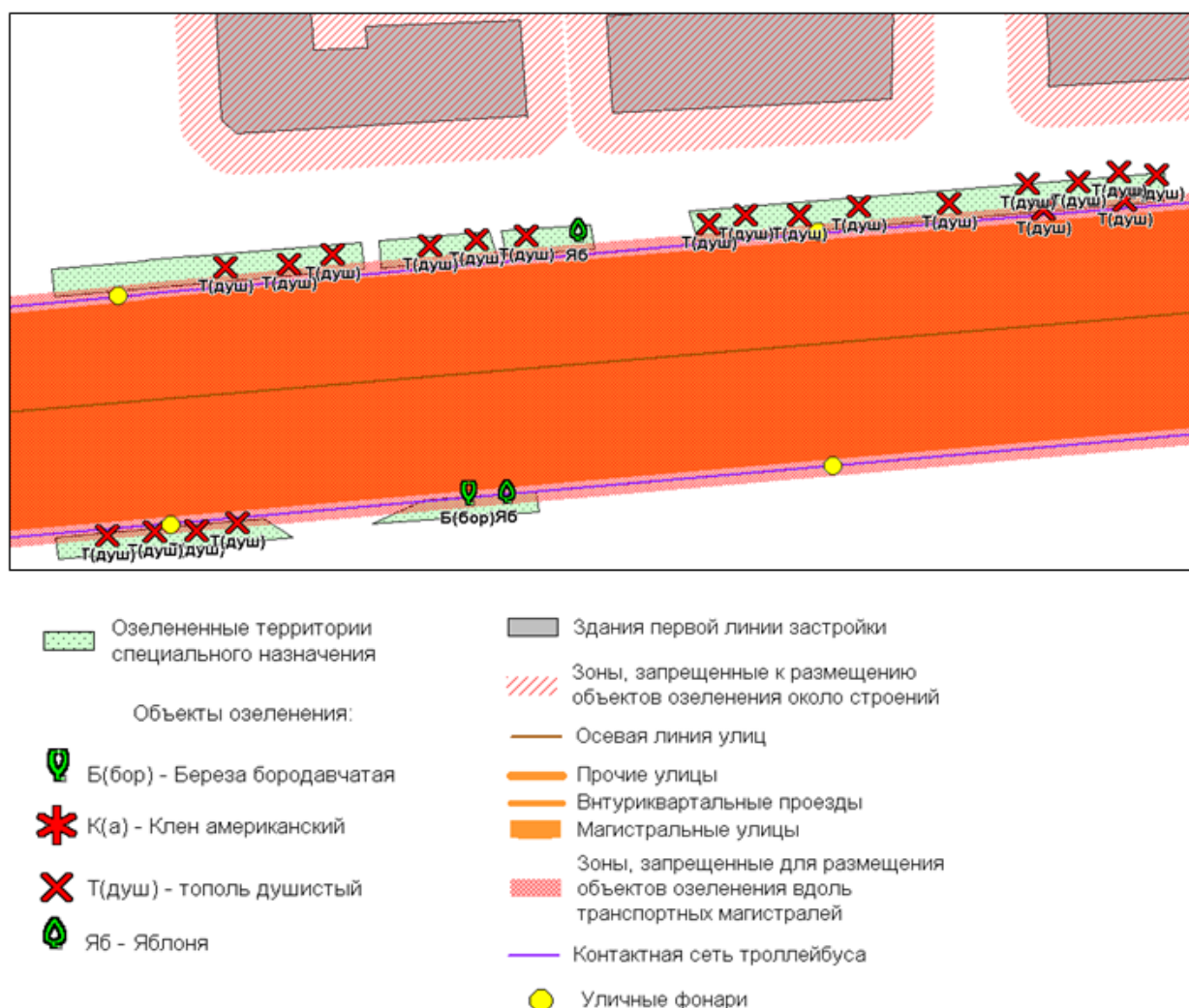
Рис. 3. Фрагмент цифровой схемы озеленения на участок улицы Титова (Ленинский район г. Новосибирска)
