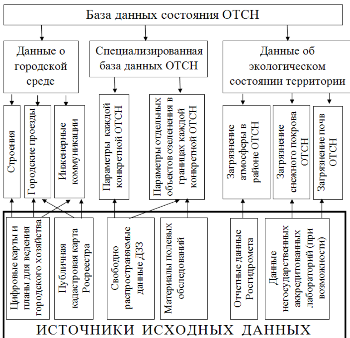
Рис. 1. Структура базы данных ОТСН и основные источники исходных данных для ее заполнения
