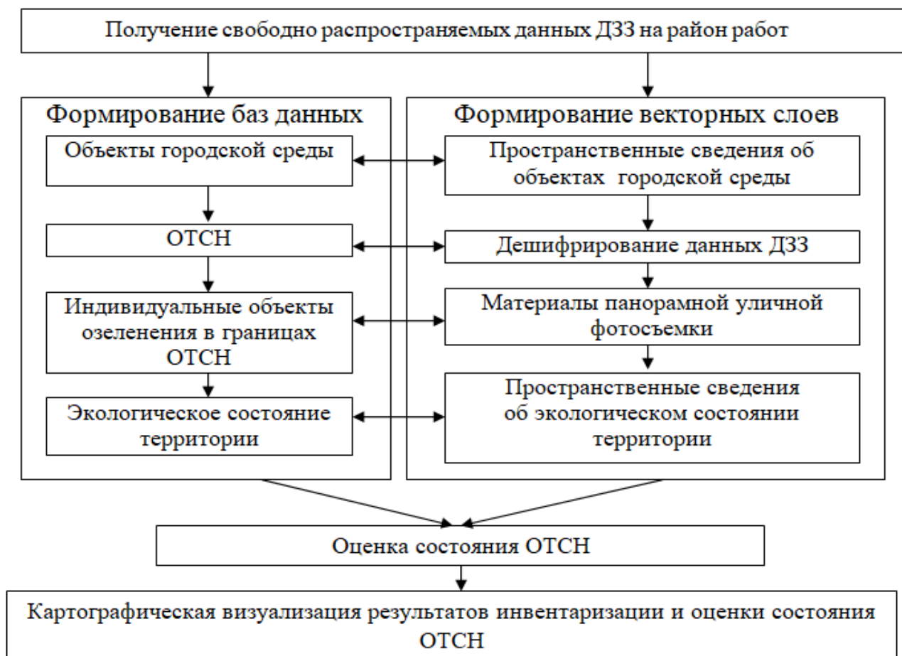
Рис. 2. Общая технологическая последовательность геоинформационного моделирования и картографирования ОТСН
