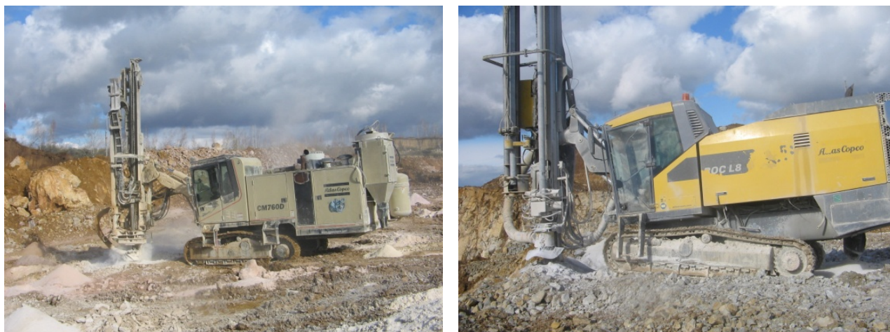
Рис. 4. Испытания пневмоударника ПВ170М на станке СМ760D (а) и на станке Roc L8 (б)
