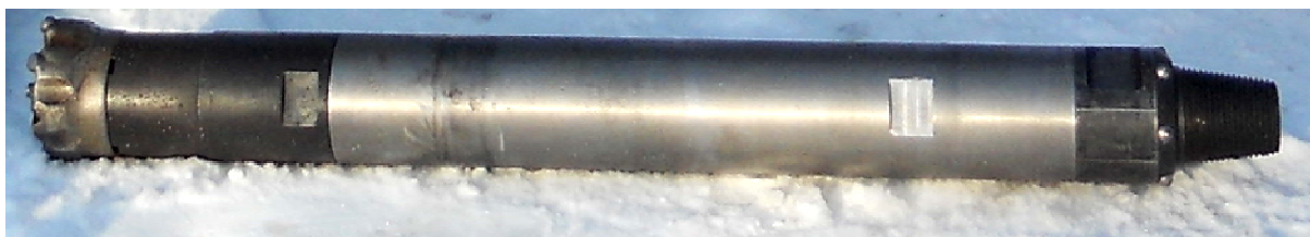
Рис. 3. Погружной пневмоударник ПВ130
