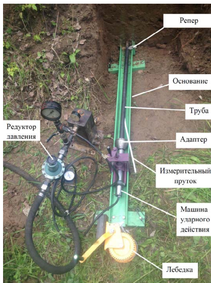
Рис. 3. Общий вид экспериментальной установки при динамическом погружении трубы
