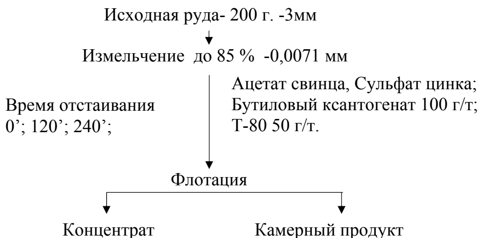
Рис. 3. Схема флотационного эксперимента с свинцово-цинковой рудой Горевского месторождения
