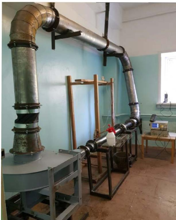
Рис. 3. Общий вид стенда для проведения лабораторных испытаний поточных датчиков
