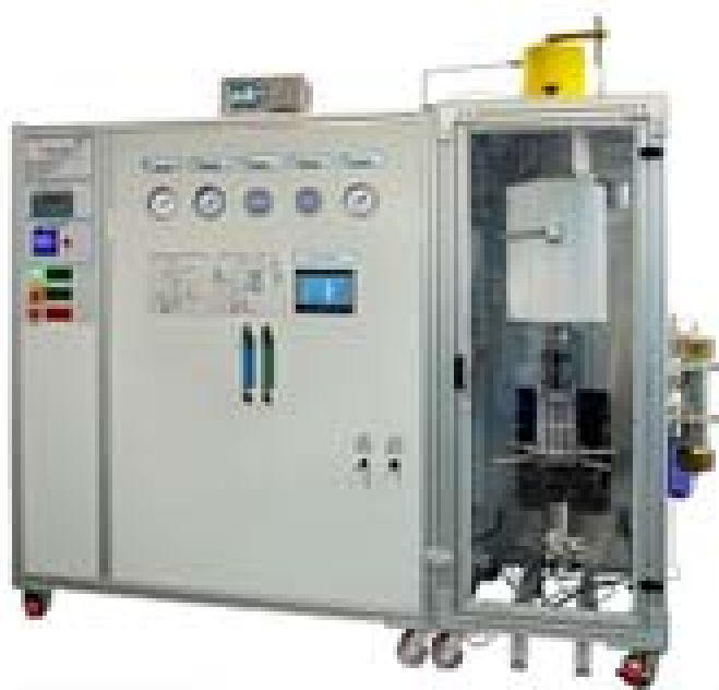
Рис. 1. Установка УИДК для исследования прочностных свойств керна в пластовых условиях производства АО Геологика
